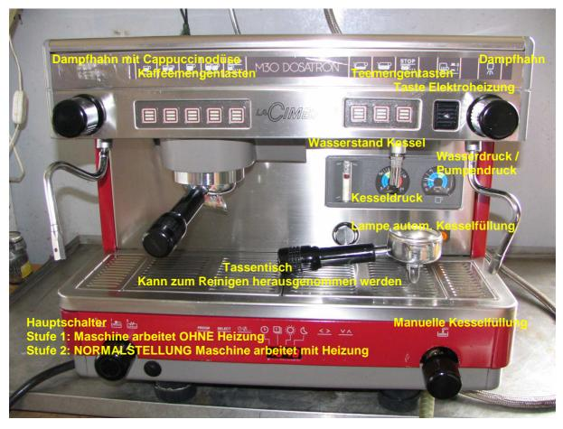
Die Stoptaste bei den Mengentasten dient zum vorzeitigen abschalten und als Dauertaste.
